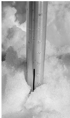
لوله شماره ۱ دارای تیغه برنده فولادی مخصوص می باشد. بر روی لوله ها، شیارهایی برای مشاهده مغزه برف و تخلیه آن و همچنین درگیری دسته پیچش دستگاه با آن وجود دارد. بر روی بدنه لوله ها دو سری درجه بندی (متريک و اينچي) حک شده است. (برای کاربران داخل کشور فقط درجه بندی متريک حک می شود.)
